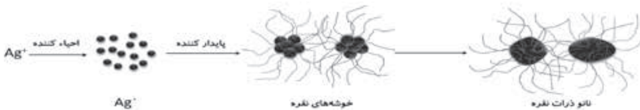
شکل ۱. روند تشکیل نانوذرات نقره به روش احیای شیمیایی
